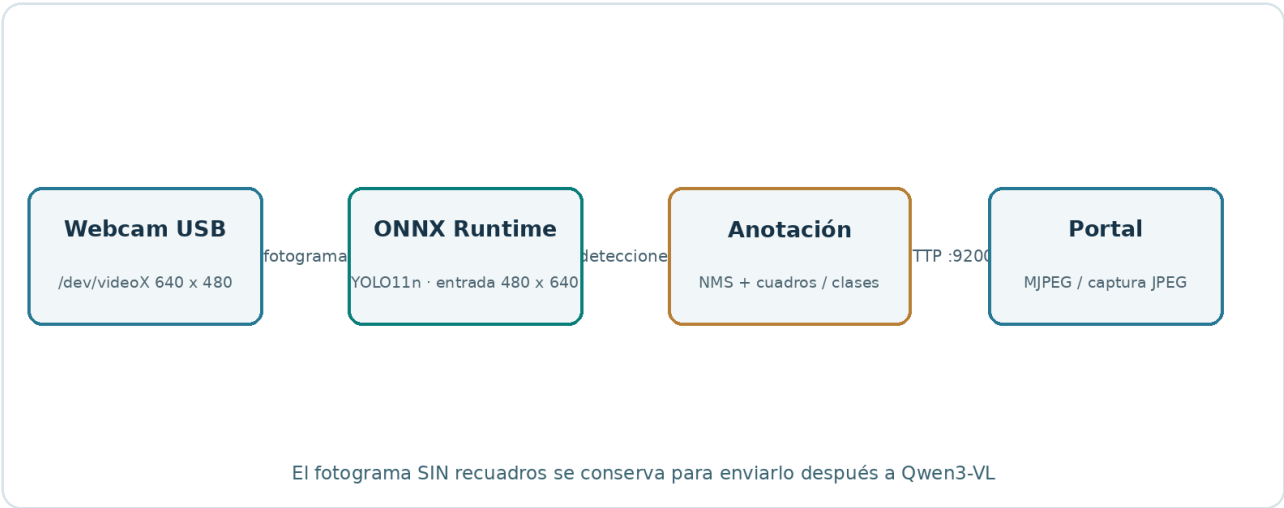
Figura 4. Captura USB en Orange Pi, inferencia YOLO en CPU ARM64 y visualización web.
